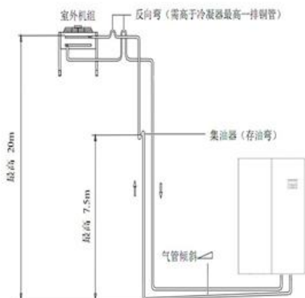
图 2-7 冷凝器高于室内机
